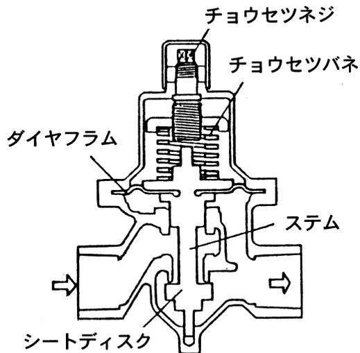
二次側に流れ出た流体の一部は、ダイアフラムの下部に達し、上向きのかとして働き、下向きのかに打ち勝ってシートディスクは弁閉します。次に、チョウセツネジを回し、チョウセツバネをたわませると、ダイアフラムは押し下げられステムを介して弁開し流体は二次側に流れます。
