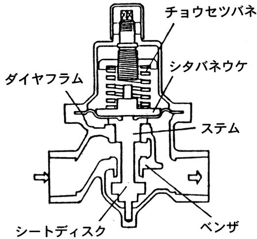
流体を流さない状態では、チョウセツバネ、ダイアフラム、シタバネウケ、ステムなどの部品質量でシートディスクはベンザより離れ、弁は開いています。
