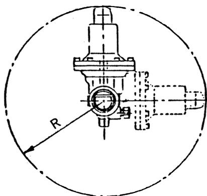
ねじ込形の減圧弁を配管に直接ねじ込んで取付ける時は、左図のR寸法が必要です。
