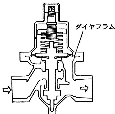
二次側に流れ出た流体の一部はダイアフラムの下部に達し、ダイアフラムを押し上げます。この二次側の圧力によるダイアフラムの上向きのかと、チョウセツバネによる下向きのかとがバランスするようにシートディスクの開度を調節して、二次側の圧力を一定に制御します。
