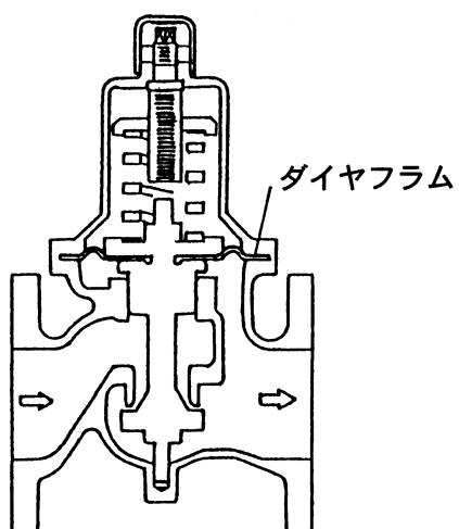
二次側に流れ出た流体の一部はダイヤフラムの下部に達し、ダイヤフラムを押上げます。この二次側の圧力によるダイヤフラムの上向きの力と、チョウセツバネによる下向きの力がバランスするようにシートディスクの開度を調節して、二次側の圧力を一定に制御します。
