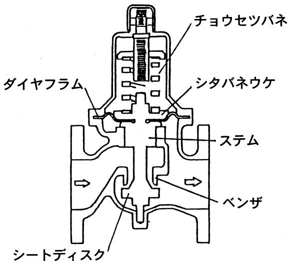
流体を流さない状態では、チョウセツバネ、ダイヤフラム、シタバネウケ、ステムなどの部品質量でシートディスクはベンザより離れ、弁は開いています。
