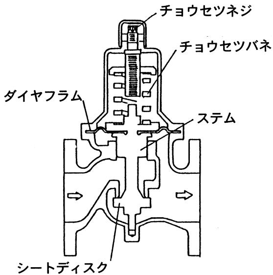
二次側に流れ出た流体の一部は、ダイヤフラムの下部に達し、上向きの力として働き、下向きの力に打ち勝ってシートディスクは弁閉します。次に、チョウセツネジを回し、チョウセツバネをたわませると、ダイヤフラムは押し下げられステムを介して弁開し流体は二次側に流れます。
