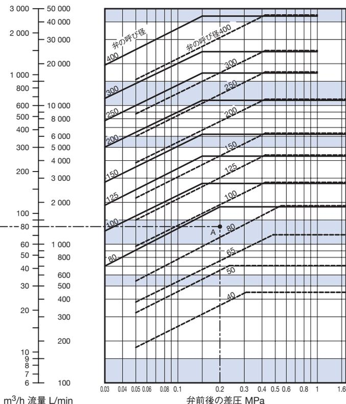
●呼び径選定図表の ---- (破線) 適用機種
