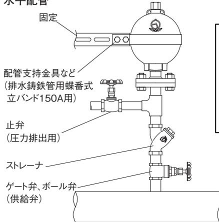
**注意** ウォータハンマ発生時には水撃防止器及び配管が衝撃により振動します。また、充水時、接続配管には水撃防止器と水の荷重が加わりますので、配管の固定は確実に行ってください。
