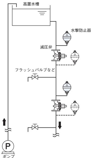
重力式（高置水槽方式等）給水からの立て配管でゾーニング減圧弁を使用して給水を行う場合、フラッシュバルブなどの作動により状況によっては、ウォータハンマによる配管の振動や騒音が発生する場合があります。
