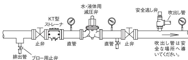
図3. 端接続がねじ込形の場合
