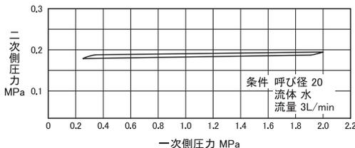
流量が0で一次側圧力1.0MPaの時、二次側圧力を0.2MPaに設定後、定格流量の10%位の流量を流しながら、一次側圧力を1.0~0.25~2.0~1.0MPaに変化させた時の二次側圧力の変動を示します。二次側圧力の変動幅=設定圧力×10%以内(最小値0.02MPa)
