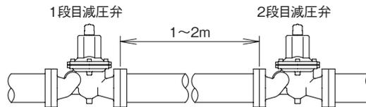
7. 中高層ビルの高置水槽方式による給水設備で、減圧弁を一段及び多段で使用する場合、状況によってはウォーターハンマが発生する場合がありますので減圧弁の一次側に水撃防止器を設置してください。(111頁参照)
