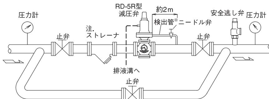
※二次側圧力検出位置は、減圧弁出口より下流約2m離してください。
