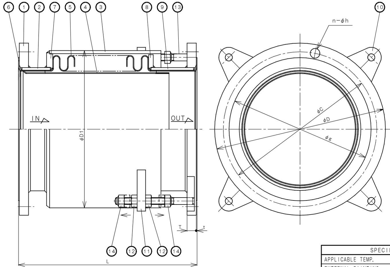
No. 12のセットナットは、配管後緩め図示の通り移動してください。
