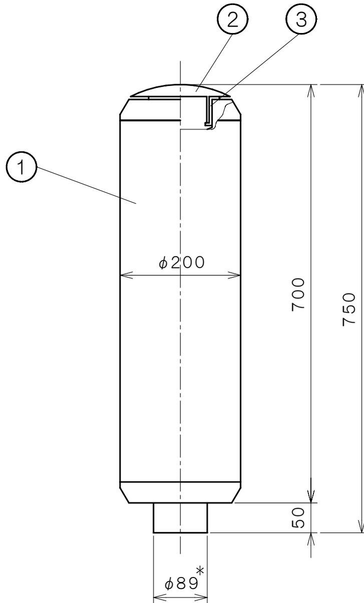
\*接続部の寸法は、VP・VU管75Aの外径と同じです。
