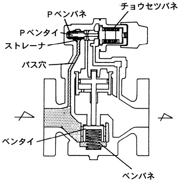
チョウセツバネがフリーの状態では、ベントイ、Pベントイは共にベンバネおよびPベンバネの力で閉止しています。一次側止弁を開き、減圧弁に流体を通しますと、流体の一部はパス穴・ストレーナを通してPベントイ室に達します。
