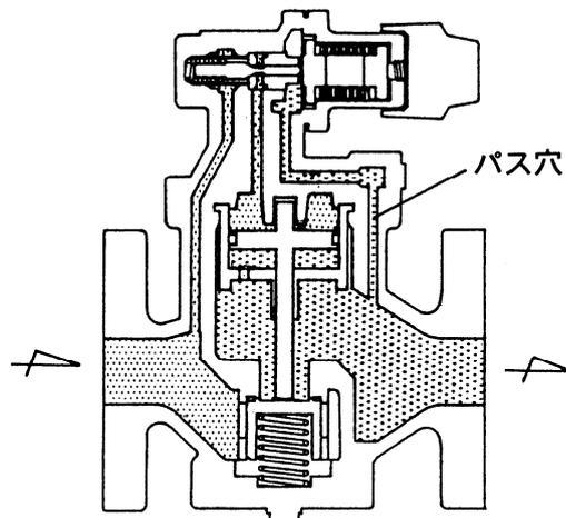
二次側に流れ出た流体の一部はパス穴を通り、ダイヤフラム下部に達しダイヤフラムを押し上げます。この二次側圧力によるダイヤフラムへの上向きの力とチョウセツバネによる下向きの力がバランスするようにPベントイの開度を調節して、二次側圧力を一定に制御します。
