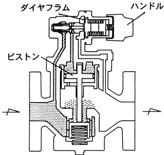
ハンドルを回し、チョウセツバネをたわませるとダイヤフラムは湾曲し、Pベントイが開きPベントイ室の流体は、ピストン上部に入り、ピストンはその圧力により下方に押し下げられ、ベントイを押し開き、流体は二次側に流れ出ます。
