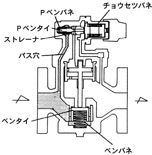
チョウセツバネがフリーの状態では、ベンタイ、Pベンタイは共にベンバネおよびPベンバネの力で閉止しています。減圧弁に蒸気が流入すると、蒸気はベンタイに達するとともに、一部はパス穴・ストレーナを通してPベンタイに達します。
