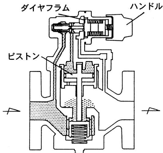
ハンドルを回し、チョウセツバネをたわませるとダイアフラムが湾曲し、Pベンタイが開きます。Pベンタイに達した蒸気はピストン上部に入り、ピストンがその圧力により下方に押し下げられ、ベンタイを押し開き、蒸気は二次側に流れ出ます。
