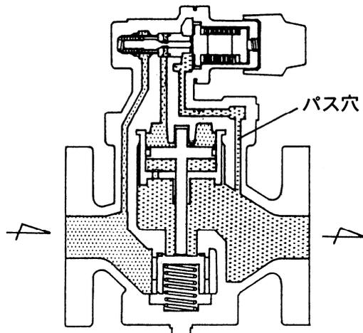
二次側に流れ出た蒸気の一部はパス穴を通り、ダイアフラムに達しダイアフラムを押し戻します。この二次側圧力によるダイアフラムへ押し戻す力とチョウセツバネによるPベンタイを開かせる力がバランスするようにPベンタイの開度を調節して、二次側圧力を一定に制御します。
