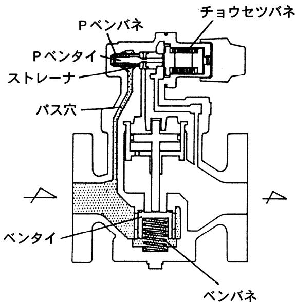
チョウセツバネがフリーの状態では、ベンタイ、Pベンタイは共にベンバネおよびPベンバネの力で閉止しています。減圧弁に蒸気が流入すると、蒸気はベンタイに達するとともに、一部はパス穴・ストレーナを通ってPベンタイに達します。
