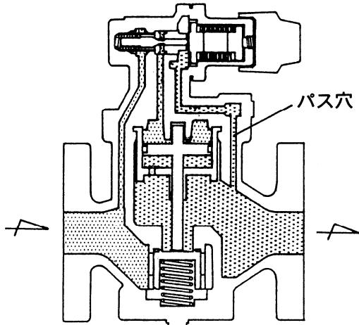
二次側に流れ出た蒸気の一部はパス穴を通り、ダイヤフラムに達しダイヤフラムを押し戻します。この二次側圧力によるダイヤフラムへ押し戻す力とチョウセツバネによるPベンタイを開かせる力がバランスするようにPベンタイの開度を調節して、二次側圧力を一定に制御します。
