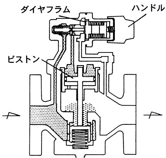
ハンドルを回し、チョウセツバネをたわませるとダイヤフラムが湾曲し、Pベンタイが開きます。Pベンタイに達した蒸気はピストン上部に入り、ピストンがその圧力により下方に押し下げられ、ベンタイを押し開き、蒸気は二次側に流れ出ます。
