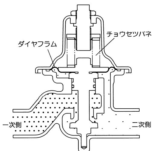
減圧弁は圧力調整された状態では弁開しており、通水すると一次側の流体は減圧され、二次側に流れます。
