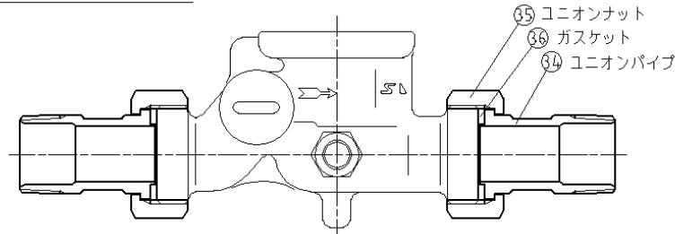
端接続：止水栓継手+オスユニオン継手付の場合
