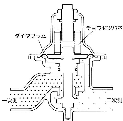
再び二次側の止弁を開けて流体を流すと、二次側圧力は下がりチョウセツバネ荷重がダイヤフラムに作用する上向きの力に打ち勝って弁開の状態となり、二次側には減圧された流体が流れ出て圧力を一定に保ちます。
