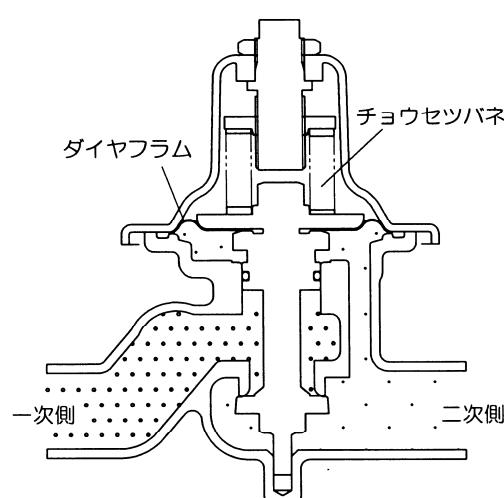
二次側の止弁を閉にすると二次側に減圧されて流れ出た流体の一部は、ダイヤフラム下部に充満しダイヤフラムを押上げる力として働き、チョウセツバネ荷重とつり合って二次側圧力を一定に保ちます。
