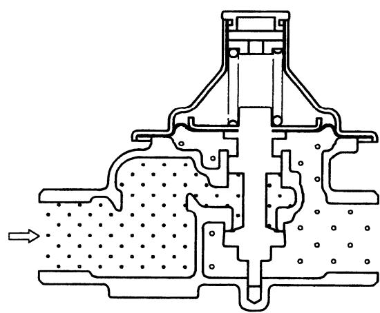
二次側の止弁を閉にすると二次側に減圧されて流れ出た流体の一部は、ダイヤフラム下部に充満しダイヤフラムを押上げる力として働き、チョウセツバネ荷重とつり合って二次側圧力を一定に保ちます。
