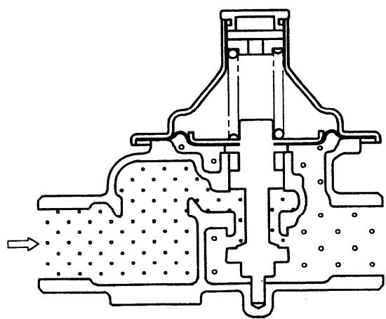
再び二次側の止弁を開けて流体を流すと、二次側圧力は下がりチョウセツバネ荷重がダイヤフラムに作用する上向きの力に打ち勝って弁開の状態となり、二次側には減圧された流体が流れ出て圧力を一定に保ちます。
