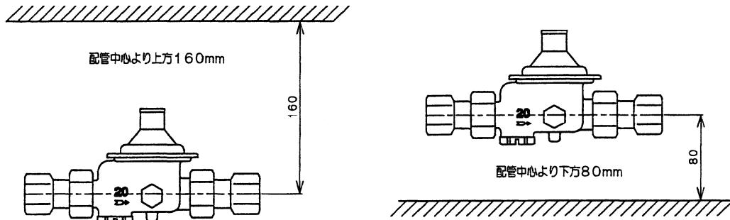
保温ケースの実寸法（圧力計付）
