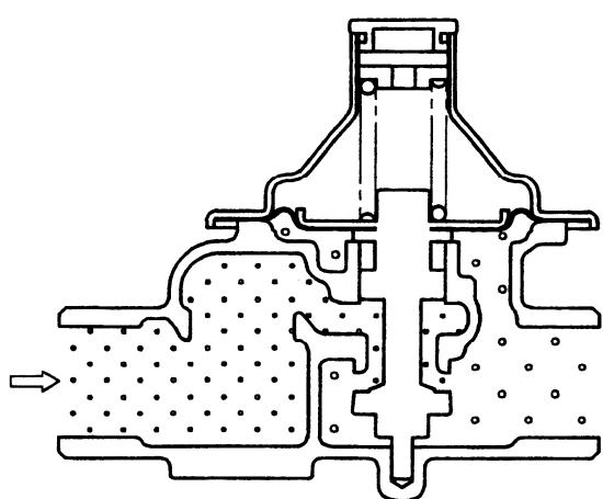
減圧弁は圧力調整された状態では弁開しており、通水すると一次側の流体は減圧され、二次側に流れます。
