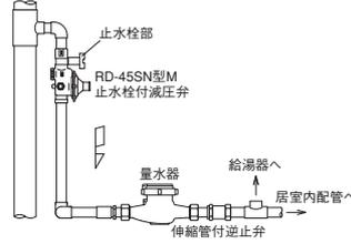
止弁(仕切弁)が不要となり、省スペース、施工性効率アップ、コスト削減が可能です。
