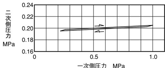
一次側圧力0.5MPaの時、二次側圧力を0.2MPaに設定し、一次側圧力を0.5~1~0.22~0.5MPaに変化させた時の二次側圧力の変動を示します。
