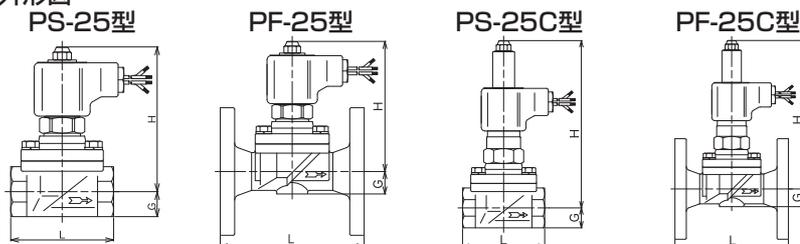
注. 呼び径により構造が異なります。(呼び径32以上はコイル部の構造が異なります。)
