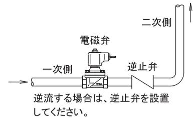
図4. 蒸気配管使用例略図
